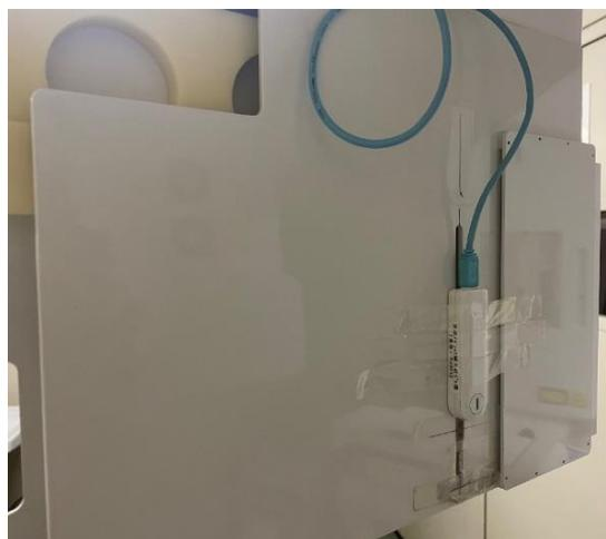
図 1. 二次スリット前面に固定した線量計位置
