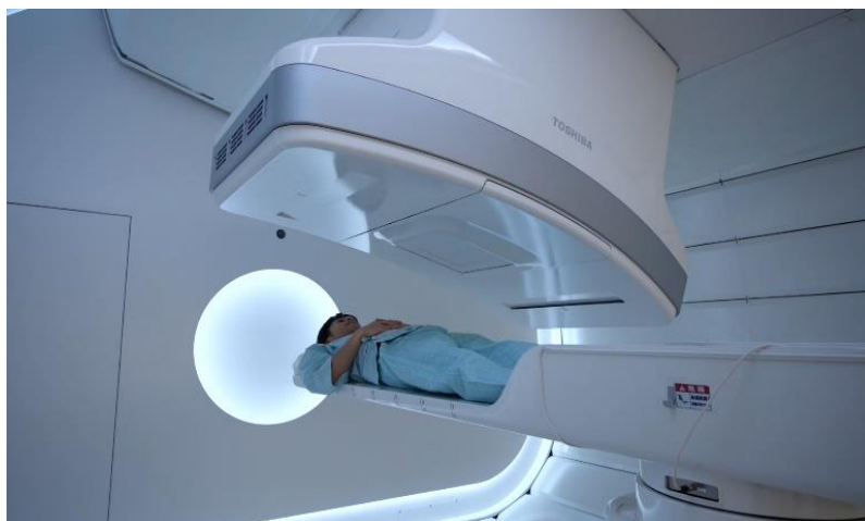
図 2 回転ガントリ照射室 360 度方向から照射可能
