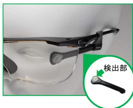
図 4 DOSIRIS (防護メガネ取り付け時)
