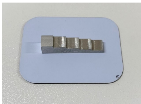
Fig.2 IP とアルミステップの配置
