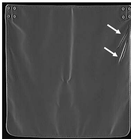
図6. 防護スカートの位置決めスキャン (矢印は亀裂部分)
