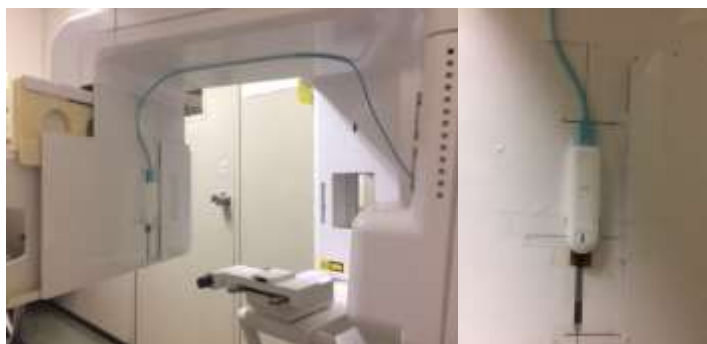
図 1 二次スリット前面に固定した線量計位置
