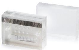
DENTEST ファントムは、デジタル口内法 X 線撮影システムの画質性能確認用に設計。これらのテストは、試運転時に実行し、パフォーマンスの低下をチェックするために定期的に行う必要がある。
