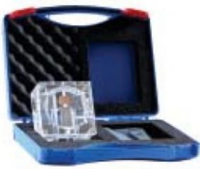
最新の高解像度デジタル口内法X線撮影システムの画質性能確認用に設計。これらのテストは、受け入れ時に実行してベースラインを確立し、定期的にテスト結果の継続的な記録を保持して、パフォーマンスの低下を示す。
