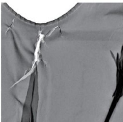
図4 破損したX線防護衣のX線透視画像
