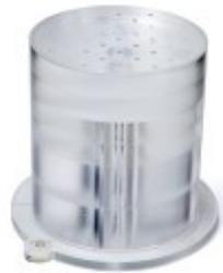
SedentexCT 線量指数 (DI) ファントムは、成人の頭部を模擬したシリンダー状の PMMA プレートがスタックで構成。以下の検出器システムで使用可。
