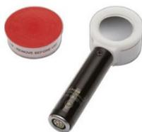
ワールドワイドで標準的に使用されているマンモ測定用チェンバで、いかなるターゲット/フィルタの組合せにも対応。10~40 keV でのエネルギーレスポンスが平坦なため、補正を要しない。また自動線量モードにて、照射時間の測定にもお奨め。時間レンジ (パルス幅) は 10 ms~9999 s までとなっている。
