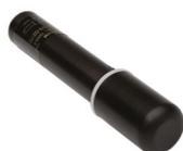
ダイナミックレンジが広く、幅広い線量/線量率測定アプリケーションに適している。また自動線量モードにて、照射時間の測定にもお奨め。時間レンジ (パルス幅) は 10 ms~9999 s までとなっている。
