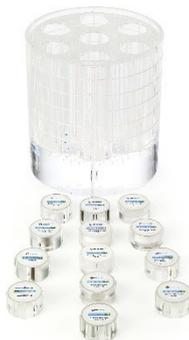
試験用インサートを収容するための凹部を有する PMMA シリンダー (直径 160 mm)。
