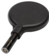
断面積 100 cm<sup>2</sup>、実効容積 180 cm<sup>3</sup> の漏洩線測定用チェンバ。またイメージレセプタのような低線量の測定にも最適。
