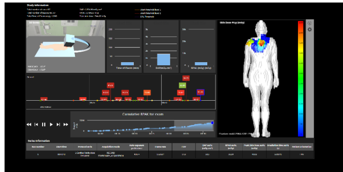
図6 再生ボタンを押すことで検査をプレイバックする、皮膚線量マップの表示画面の一例
