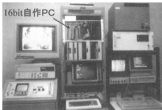
図3 大学院卒業当時の16ビットの自作したパソコン（画面中央） デジタルパノラマ装置のデータ処理に使用
