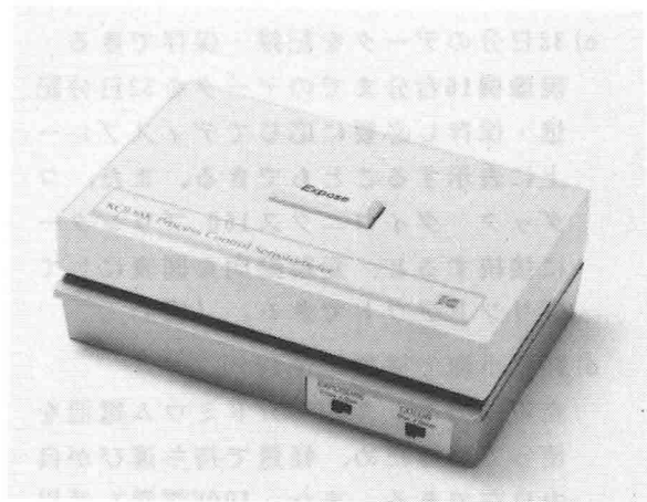
図1 コダック プロセス コントロール センシトメーター
