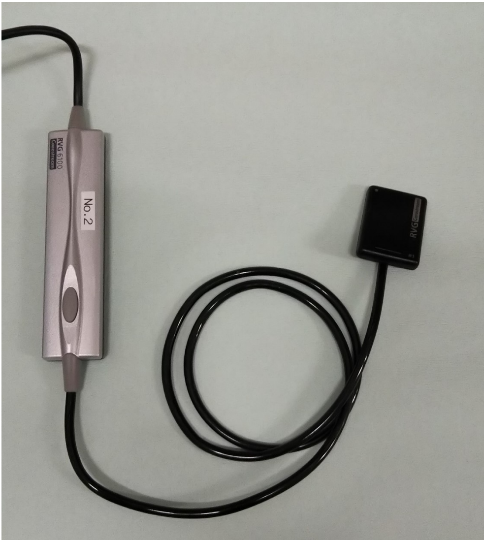
図 15 デンタル用 CCD センサー。右側の黒いセンサーにカバーをかぶせ使用する。
