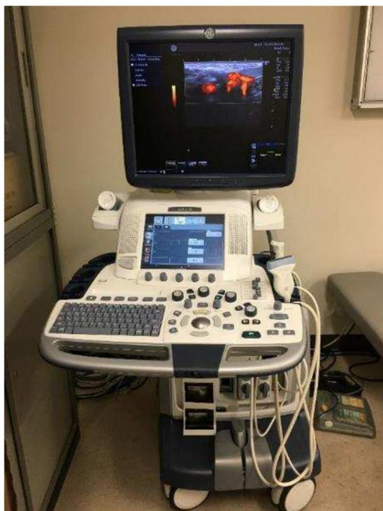
プローブ・・・先端から超音波が出ています。
